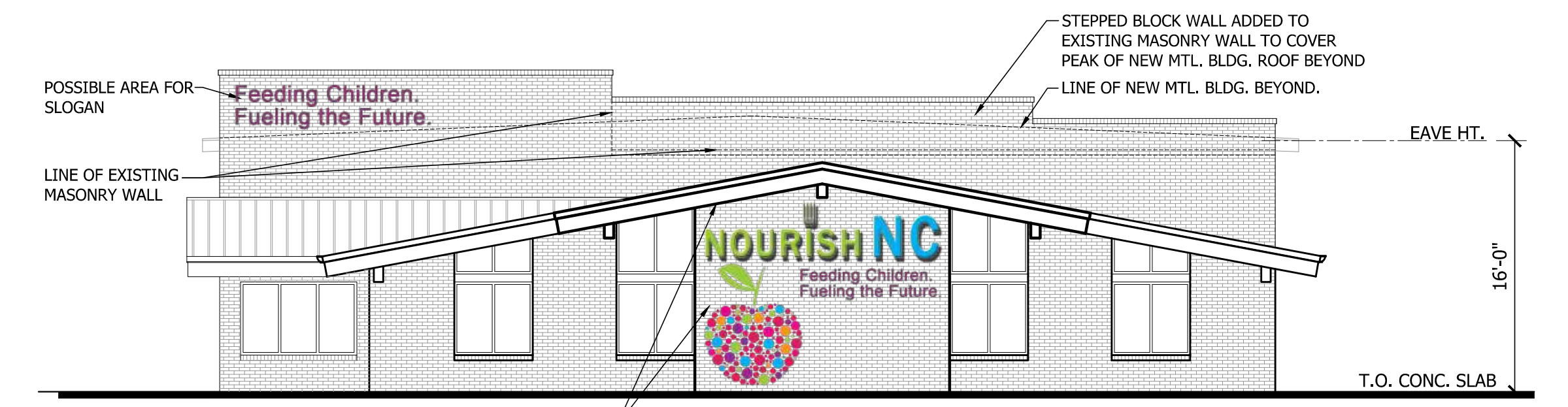
B FRONT ELEVATION SCALE: 1/8" = 1'-0"
